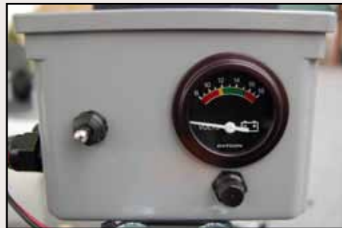
Battery volt meter
